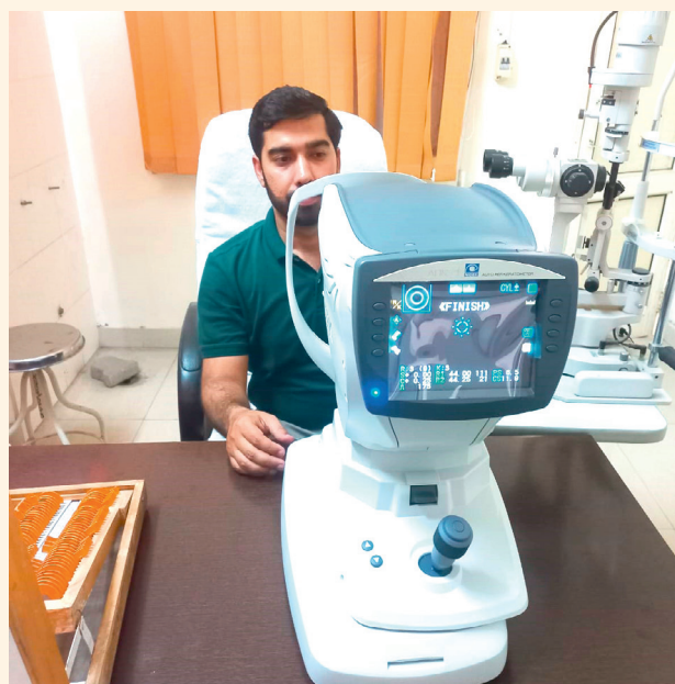
Foto: Das zweite Gerät, ein Keratometer zum automatischen Ausmessen des Auges.
